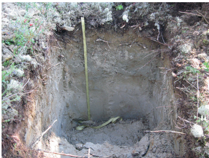
Рис. 3. Профиль глеезема суглинистого, подстилаемого песчаными отложениями, вскрытый разрезом в районе геологоразведочной площадки 4727Р
