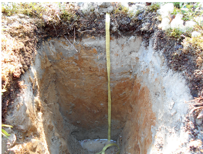
Рис. 2. Профиль подзола глееватого в кедровом лесу, вскрытый разрезом в районе геологоразведочной площадки 364Р. Уровень почвенно-грунтовых вод 95 см
